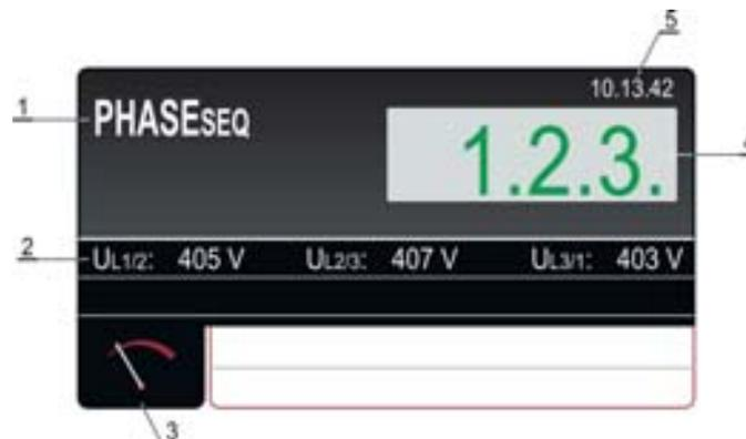
Fig. 67: Pantalla con el resultado de la prueba PHASE SEQUENCE
