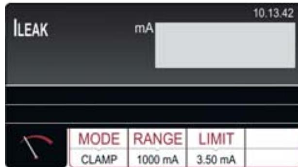
Fig. 71: Pantalla inicial de la función ILEAK
