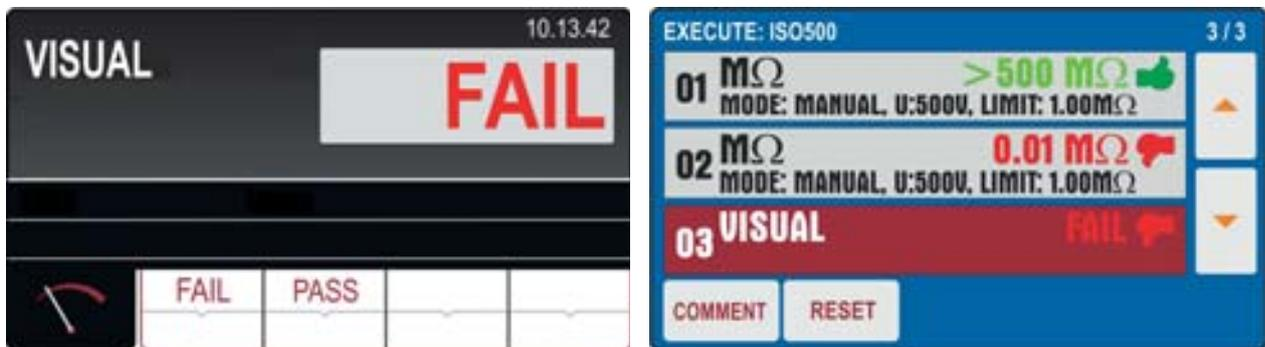
Fig. 79: Función AUTO TEST – Resultado final Autotest
