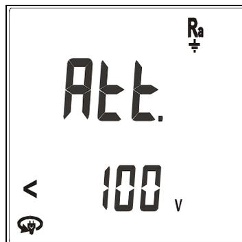
Esta condición puede verificarse, a título de Ejemplo, cuando el cable negro se conecte erróneamente al conductor de neutro en vez de al conductor de fase. Si se utiliza el cable shuko gire la clavija y repita la prueba
