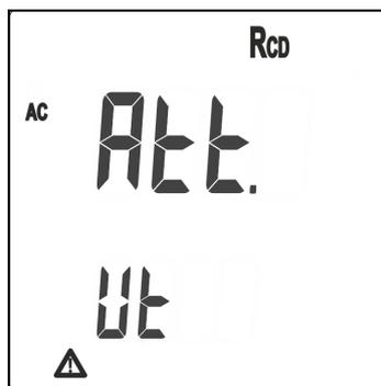
5. **Con corriente de prueba 30mAx5** cuando en la medida se detecte una resistencia de tierra más elevada, en tal de impedir al instrumento la generación de la corriente de prueba, el instrumento no efectúa la prueba. Será emitida una señal acústica prolongada señalando la situación anómala y será visualizada la siguiente ventana durante 5 segundos los cuales el instrumento visualiza la ventana de defecto relativa a la prueba RCD
