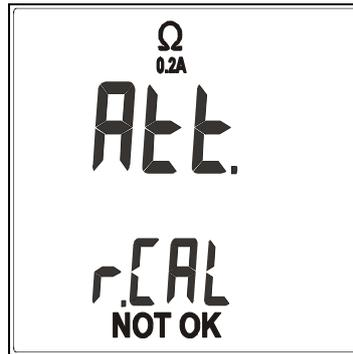
2. Si, al efectuar la medida, la tensión presente en las puntas de prueba es mayor de 10V, el instrumento no efectua la prueba. Será emitido un señal acústica prolongada indicando la situación anómala y se visualizará la ventana siguiente durante 5 segundos, transcurridos los cuales el instrumento visualiza la ventana de defecto relativa a la prueba  $\Omega$  0.2A
