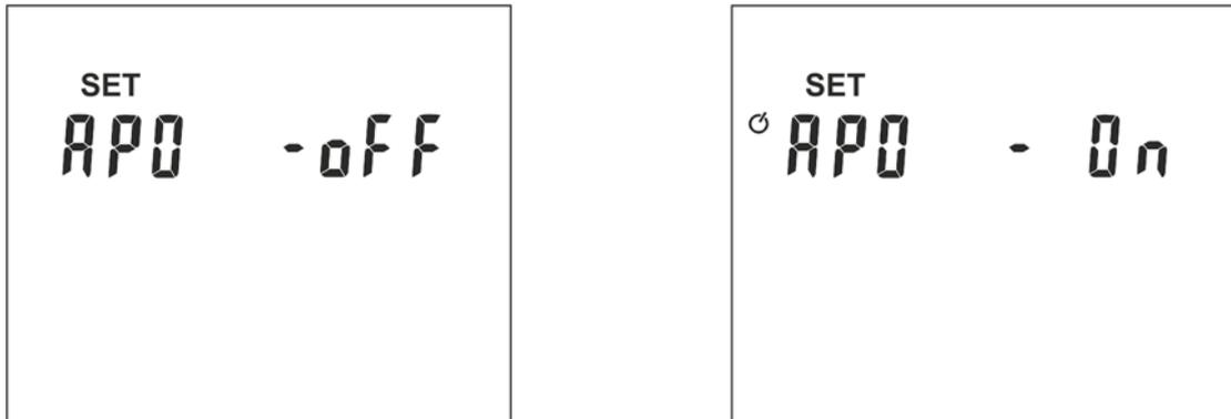
Fig. 3: Configuración autoapagado (APO)
