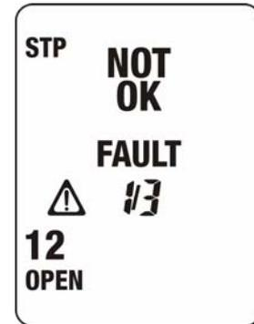
7. Si el instrumento detecta la presencia de una tensión  $> 0.2 \text{ V}$  en la entrada RJ45 muestra el mensaje mostrado en la pantalla en la derecha y no ejecute el test. Eliminar la causa de la presencia de voltaje (por ejemplo: de acoplamiento debido a la presencia de cables eléctricos en las proximidades de cable de redes LAN). **La máxima tensión permitida entre entradas es de 24V**
